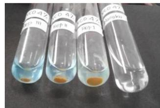
Gambar 1. Fehling Test
